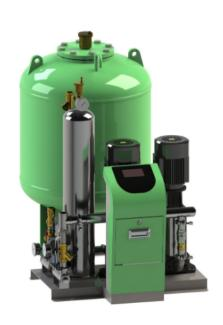
定压补水真空脱气装置: 〉定压精度□0.01mpa□保持系统稳定工作〉称重传感器精度: 1%范围0-2000kg>排除游离气体: \*\*〉排除溶解气体: 98%〉排气模式: 常压隔膜罐排气/真空排气模式二种〉压力传感器范围□0-16bar>真空罐有效容积□12L>控制部分(可选□□PLC集中控制,液晶中文功能显示,具备远程监控能力产品用途●用于生产、消防、生活系统加压供水,一般称之为囊式自动给水装置。●用于采暖、空调系统中作为稳压膨胀补水设备使用,一般称之为囊式落地式膨胀水箱。喜蓝(上海)环境科技有限公司加药装置值得用户放心。江苏变频补水装置公司
